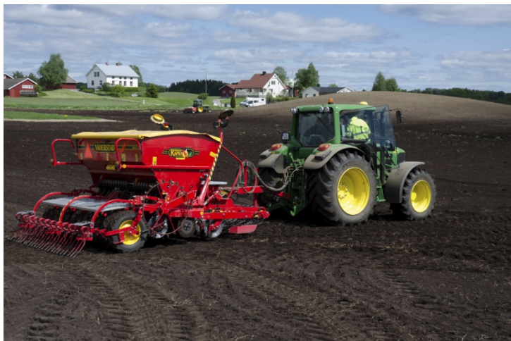
Figur 3. Såing med Väderstad Rapid. Foto av Christoffer Stenberg 2012
