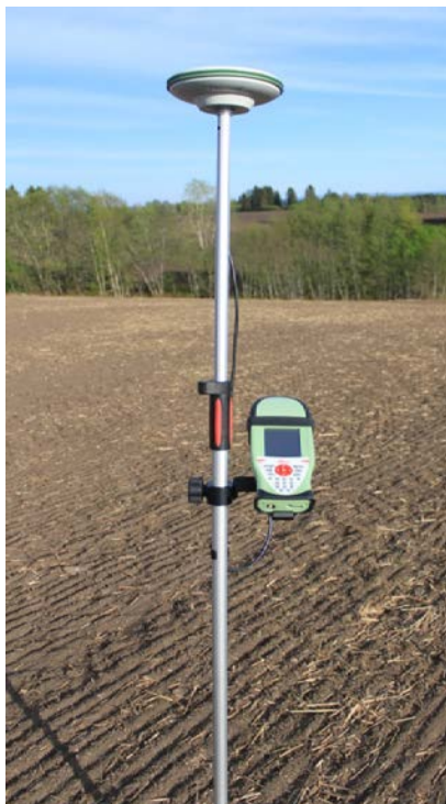
Figur 1 - Leica CS10 med stang og ekstern antenne. Foto Simen Bergseng.
