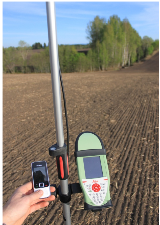
Figur 3 - Leica CS10 med mobiltelefon som mottaker av korreksjonssignal. Foto Simen Bergseng.
