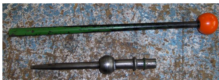
Figur 95: Den gamle girspaken etter at den har blitt kappet, av forfatteren, 2013.
