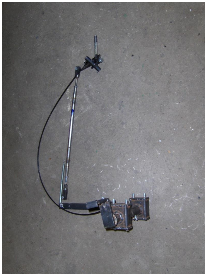
Figur 101: De nye girspakene med overføringer, av forfatteren, 2013.
