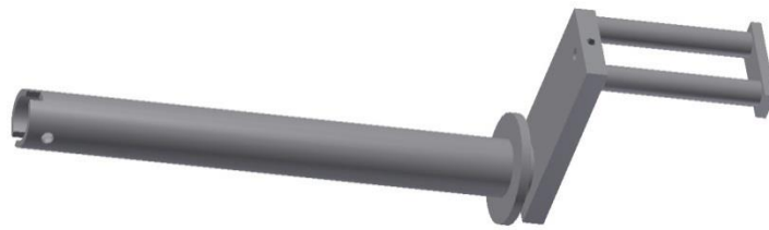
Figur 64: Ny aksel inni hylse under gulv, av forfatteren.
