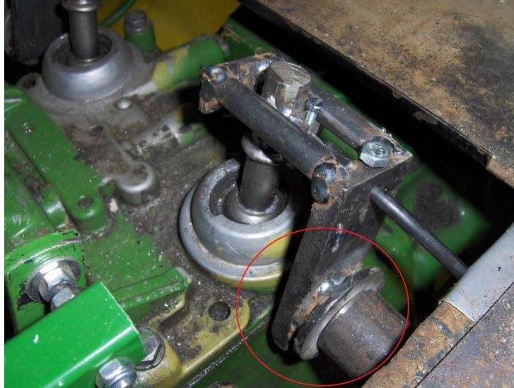
Figur 115: Sveis mellom aksel og flattjern, av forfatteren, 2013.
