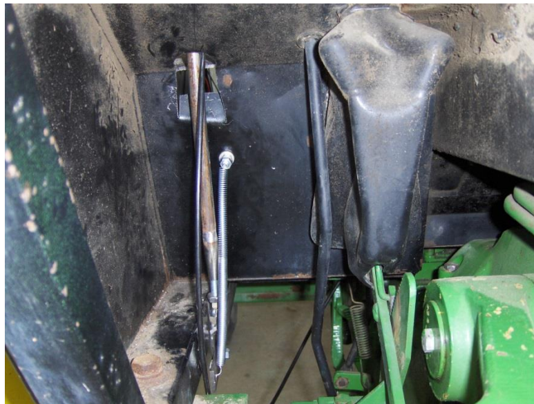
Figur 113: Ettermontering av fjær på ny giroverføring, av forfatteren, 2013.
