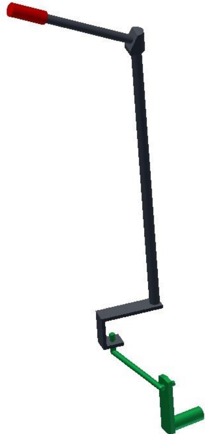
Figur 44 t.v.: Original hurtiggir betjening i traktoren, av forfatteren, 2013.
