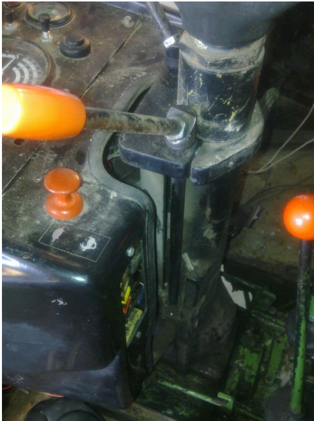
Figur 44 t.v.: Original hurtiggir betjening i traktoren, av forfatteren, 2013.
