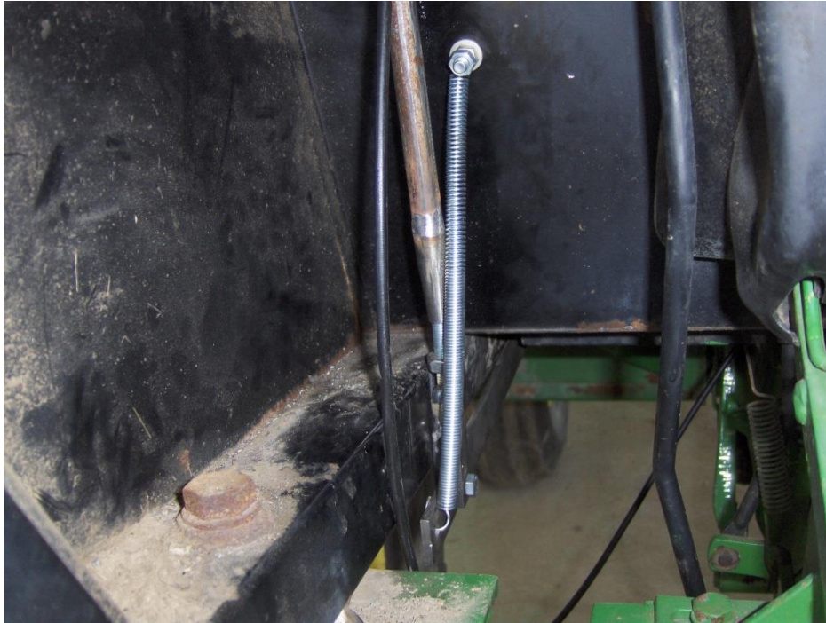
Figur 98: Armen under gulvet som festes i strekkfisken, som videre går opp igjennom gulvet til den nye girspaken. En fjær er festet til armen for å hjelpe til å holde flattjernet i riktig posisjon. Bildet er tatt bakfra under traktorhytten, av forfatteren, 2013.
