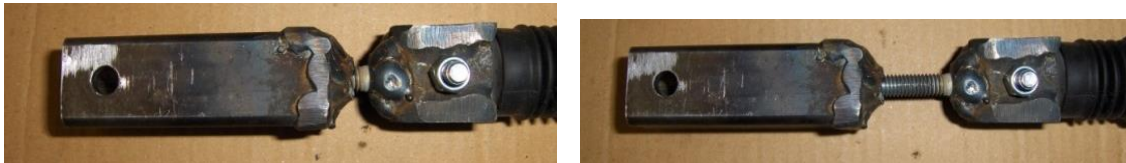
Figur 53 t.v.: Brakett på ny hurtiggirenhet med lengdejusterbart ledd, minste lengde. Av forfatteren, 2013.
