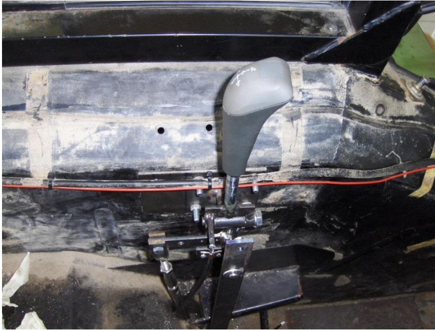
Figur 100: Den nye girspaken på venstre siden inne i førerhytten, bilde tatt ifra førersetet. Av forfatteren, 2013.
