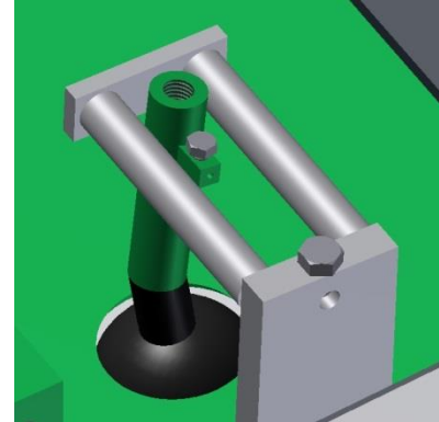
Figur 73: Gammel girspak kappet og med innfestning til ny vaier, av forfatteren, 2013.
