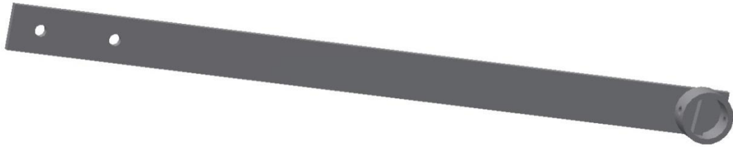
Figur 67: Flattjernet som går bakover, og er festet til akselen under gulvet, av forfatteren, 2013.
