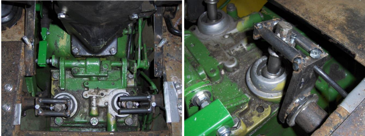
Figur 96: Ny overføring, akselen som sitter under gulvet og er tredd over den eksisterende avkappede girspaken. Av forfatteren, 2013.
