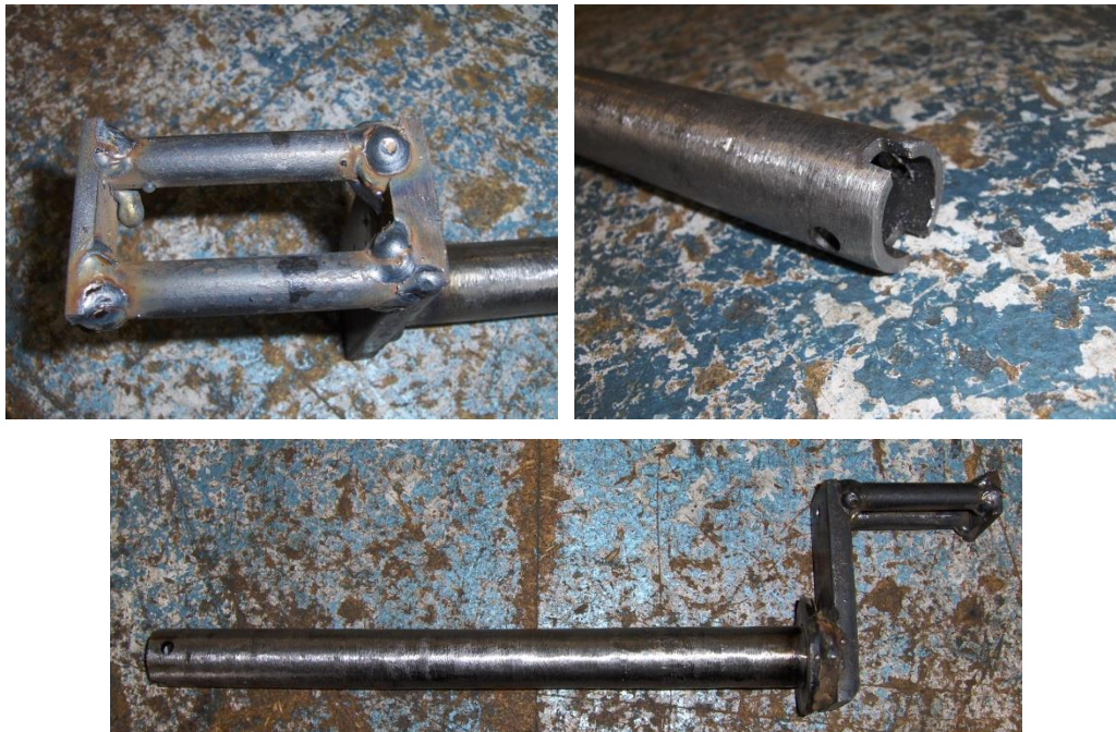
Figur 82: Akselen som skal inn i hylsen under gulvet, av forfatteren 2013.
