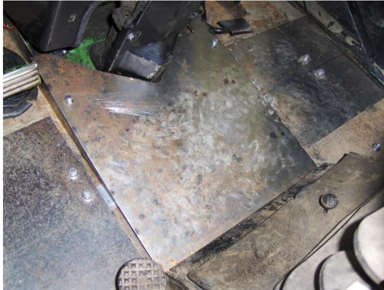
Figur 112: Plater oppå gulv som forsterkning, av forfatteren, 2013.
