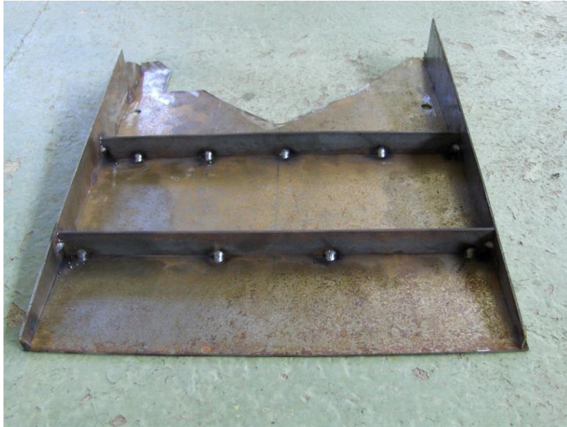
Figur 104: Avstiving av gulvet, av forfatteren, 2013.
