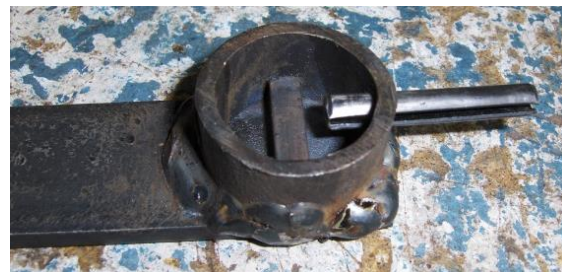
Figur 83: Innfestning på flattjernarm til aksel, av forfatteren, 2013.
