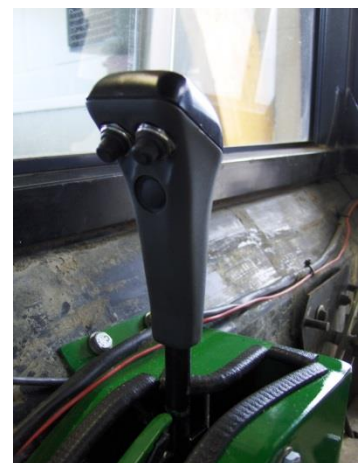
Figur 62: Ny hurtiggirbetjening på høyre girspak, av forfatteren, 2013.
