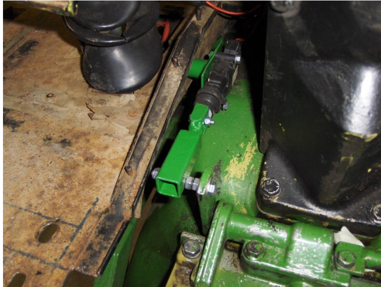
Figur 59: Ny hurtiggirenhet montert i traktor, av forfatteren, 2013.
