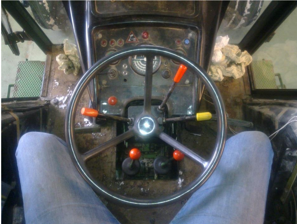
Figur 110: På bildet ser vi den gamle plasseringen av betjeningsinnretninger for gir og hurtiggir. Girspakene på gulvet mellom beina, og hurtiggirspaken til venstre for rattstammen (rødt håndtak). Av forfatteren, 2013.
