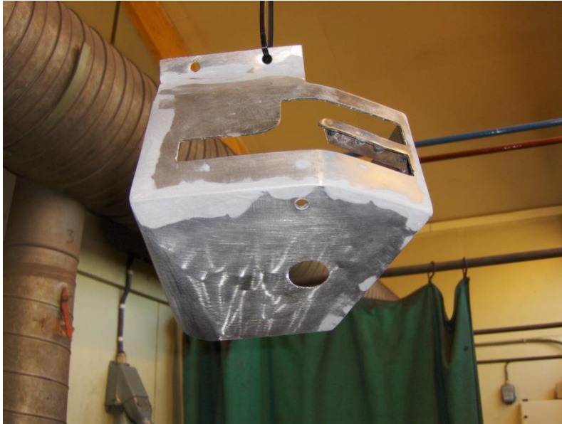
Figur 108: Nytt girdeksel venstre, sett fra oversiden. Av forfatteren, 2013.
