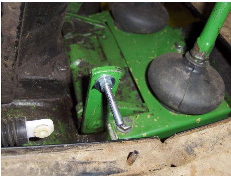
Figur 58: Festebolt til ny hurtiggirenhet på hurtiggirhendel, av forfatteren, 2013.
