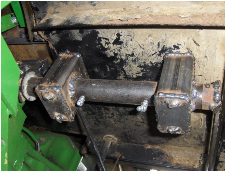
Figur 97: Hylse under gulvet, sett under forfra. Armen som går bakover ses helt til høyre i bildet, av forfatteren, 2013.
