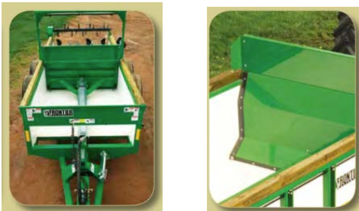
Figur 8 Gjødselvogn med hydraulisk vegg hentet fra
