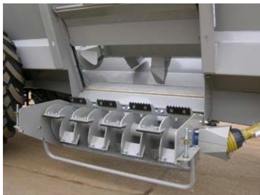
Figur 14 Spredersystem fra vogn med sideutkast hentet fra http://www.shelbourne.com/3/products/2/livestock/3_powerspread-manure-spreader/101_powerspread-pro-lwb den 27.mai 2013.
