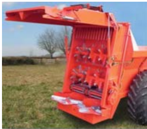
Figur 12 Bildet viser en vogn fra Ktwo med (fra bunn mot topp av bildet) sprederskiver, bunnbelter, oppmalingsrotorer og hydraulisk luke. Hentet fra http://www.ktwosales.co.uk/assets/PDFs/Bio-leaflet.pdf den 26.mai 2013.
