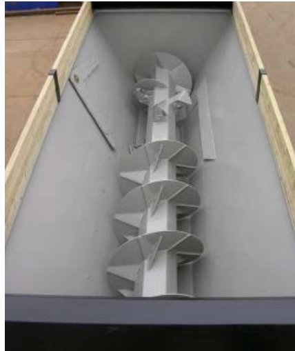
Figur 13 Bunnskrue i gjødselspreder med sideutkast hentet fra http://www.shelbourne.com/3/products/2/livestock/3_powerspread-manure-spreader/101_powerspread-pro-lwb den 27.mai 2013.
