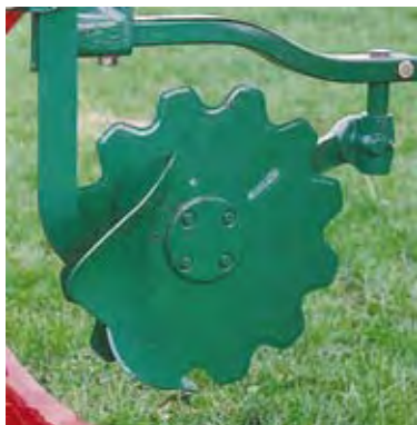
Figur 9. Takket rulleskjær går bedre i halm.
