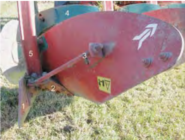
Figur 3. 1. Landside, 2. Salen, hvor plogkroppens deler er festet, 3. Veltefjølstrever som kan justeres i lengde for å endre veltefjølens vinkel og få vinkelen til alle veltefjølene like. 4. Skumfjøl, 5. Ås. Foto: Kjell Mangerud.
