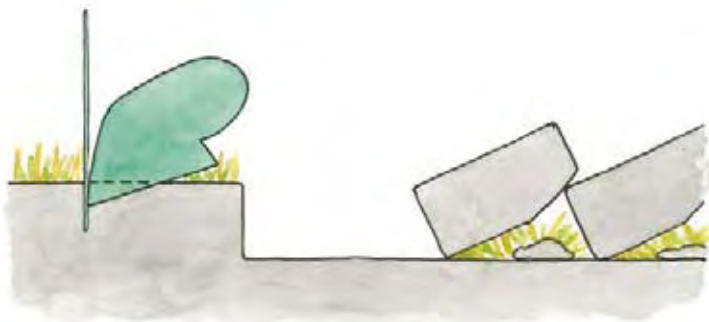
Figur 12. Forplogen sitter ved siden av rulleskjæret. Den skjærer av en trekant på toppen av velta og kaster den ned i boten av fåra. Når velta snus rundt, vil det ikke stikke opp noe halm eller grønne plantedeler. Det blir langt ned til torv, ugras og halmrester. En unngår å dra dette opp igjen når en harver. Ved spissen på forplogen, bør dybden være ca. 5 cm. Tegning: Hermod Karlsen.
