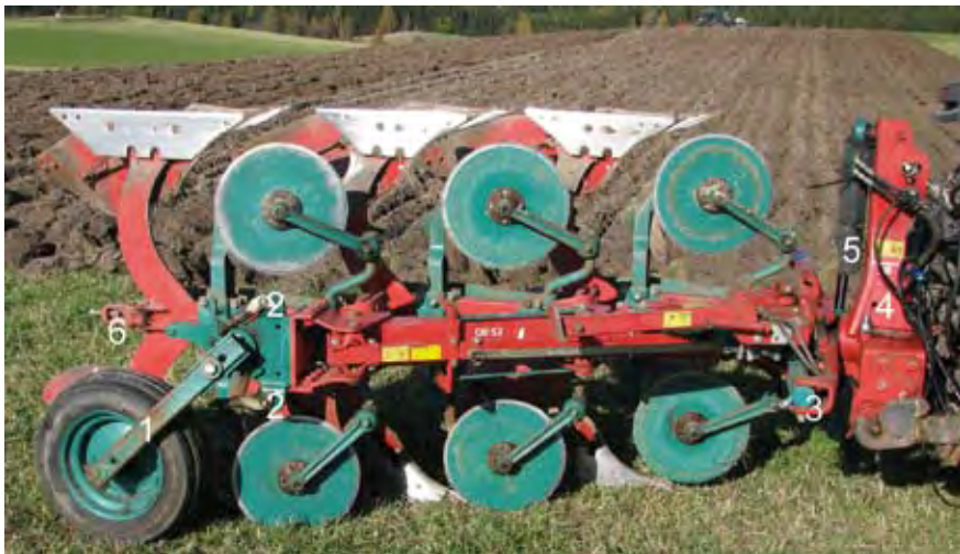
Figur 4. Vendepolg. 1 Dybdehjul, 2. Justerbare anslag for dybdehjul høyre og venstre plog, 3. Hydraulisk sylinder for justering av bredda på første plogkropp, 4. Vendehode, 5. Vendesylinder, 6. Justering av utøserfjæra. Foto: Kjell Mangerud.
