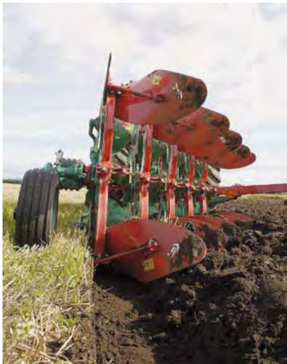
Figur 32. Plogens åser skal stå vinkelrett på bakken. På dette bildet kan det se ut som de heller mot pløgsla.
