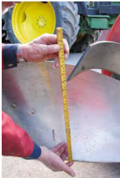
Figur 28. En kan kontrollere at skumfjølene står like høgt ved å måle fra undersiden av veltefjola til spissen på skumfjola. Foto: Stein Jørgensen.
