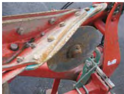
Figur 5. Her må skjæret skiftes. Det har allerede blitt slitasje på salen, og skjæret er så smalt at det ikke blir tilstrekkelig gjennomskjæring og det vil være problemer når en skal velte oppover bakke. Spissen er slitt så mye at den må snus. Foto: Kjell Mangerud.
