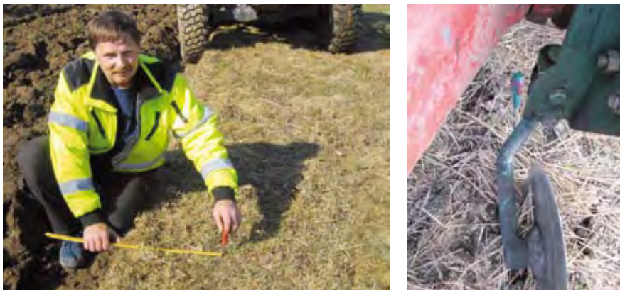
Figur 31. Det settes ned en skrutrekker, e.l. like langt fra fårkanten som veltebredda. Når en kjører fram, skal rulleskjæret på første plogkropp treffe skrutrekkeren. Denne metoden kan en også bruke når en har smalere dekk dersom en er usikker på om bredda er korrekt. Foto: Kjell Mangerud og Stein Jørgensen.
