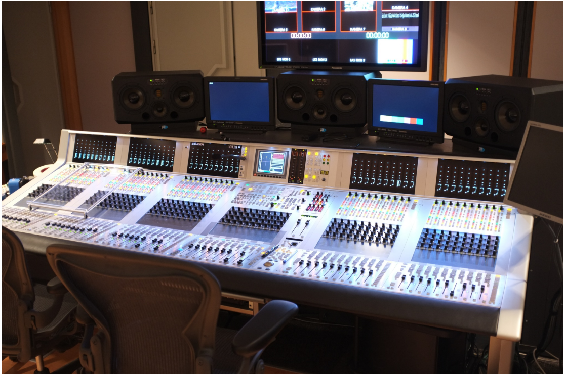
LK1, med Studer Vista 8 lydmixer, påsynsskjermer og Adam SX3-H høyttalere til kringlyd-lytting (kun L, C or R synlig i dette bildet).
