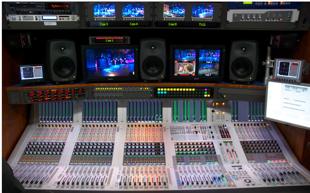
Figur 8: Lydkontrollen i NRKs OB-buss HD2 med Studer Vista 9-mikser
