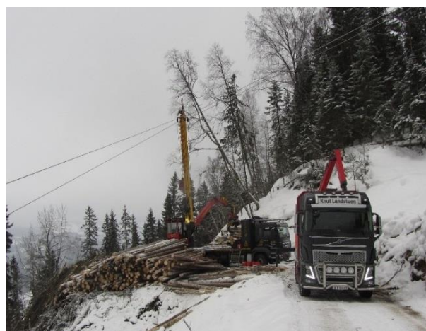
Bilde 3 Trang standplass på Tretten, tømmerbilen må kippe og kranfører får mye dobbelhåndtering av tømmeret, da tømmerbilen ikke når alt selv med tømmerkloa. Foto: Håkon Skjetne Holmli.
