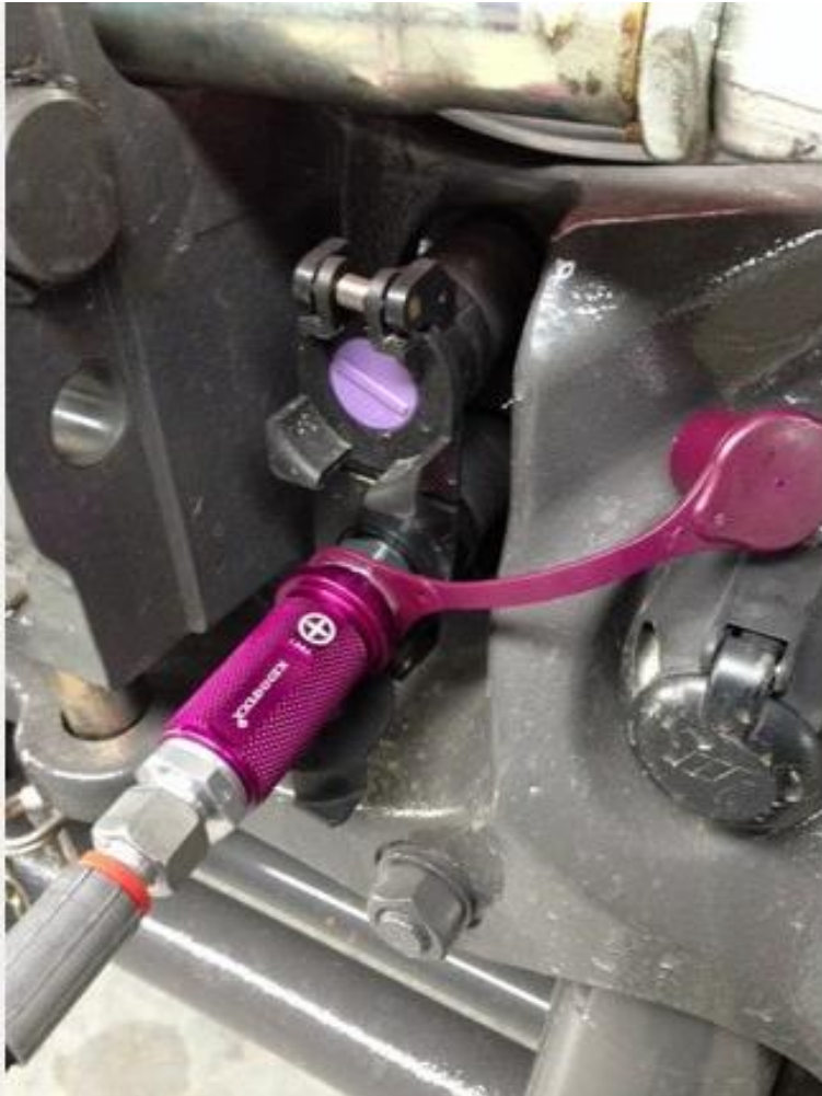
Bilde 20. Kennfixx aluminiumshylse, 2014. Lokalisert på http://www.schlauchgriff.de/kennfixx_praxis.html .
