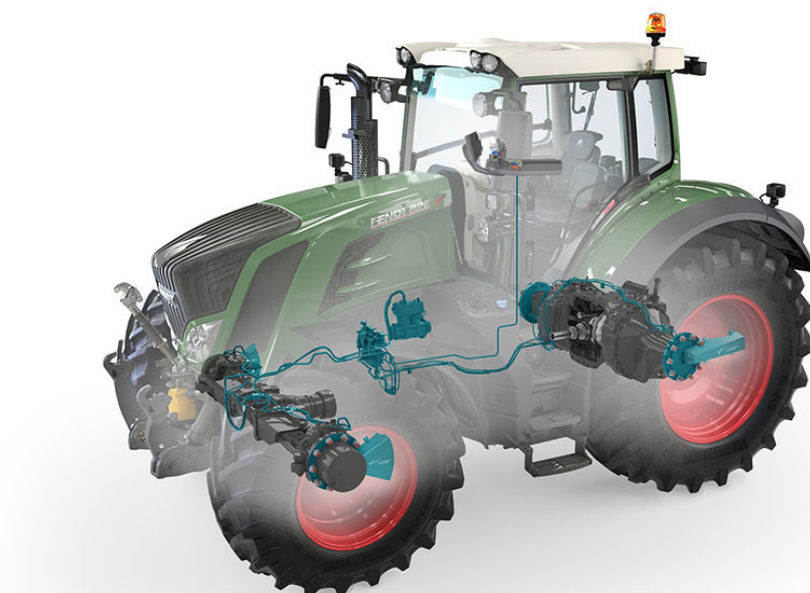
Figur 8. Viser Fendt VarioGrip sine tilhøyrande komponentar. Henta 15.04.16 frå nettsida: http://www.fendt.com/no/10041.asp
