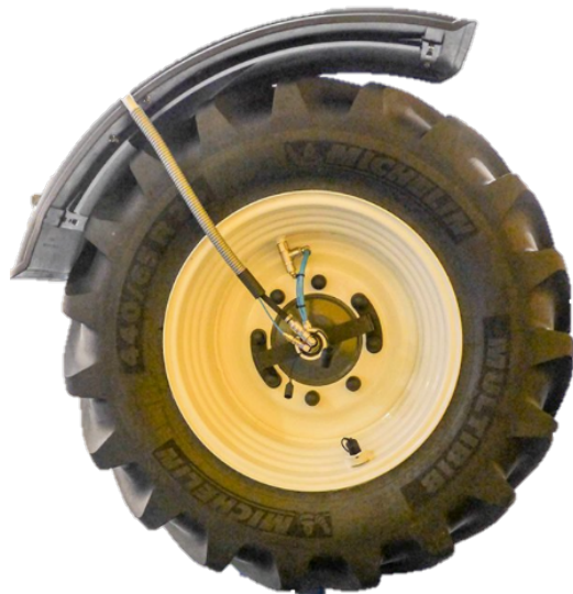
Figur 10. Modell av lufttilførselen til dekket, med eit av PTG sine system. Henta 18.04.16 frå nettsida: https://www.facebook.com/PTG-Reifendruckregelsysteme-716990288388126/photos
