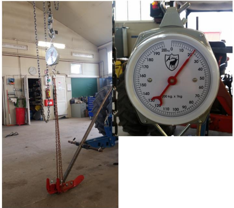
Figur 19: Det ble foretatt ei veiing av såskia uten ekstra belastning, for å vite hva minstevekta kom til å bli under kjøring. Veiinga viste at såskia hadde ei vektbelastning på 21,5 kg.
