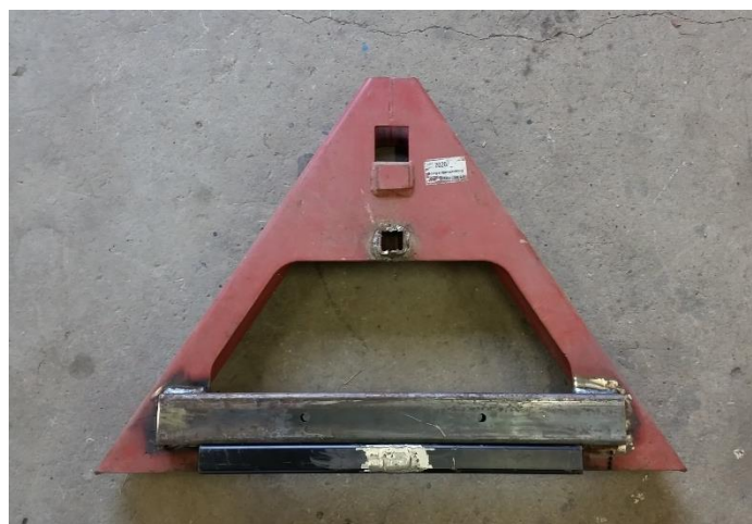
Figur 14: Firkantprofilen på 80x40 mm ble sveiset fast til triangelkoblingen. Foto av forfatter, 2016. Brukt med tillatelse.
