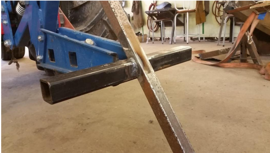
Figur 17: Sammenføring av 30x30 mm firkantprofil og redskapslabb. Sveiset fast med en vinkel på 120° i forhold til kjøreretning. Foto av forfatter, 2016. Brukt med tillatelse.
