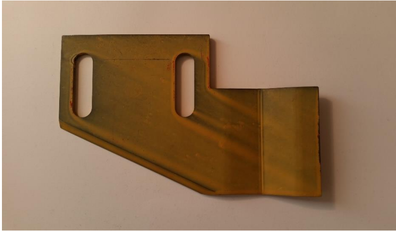
Figur 11: Slik ser original kniv ut, med 25° vinkel og 3 mm tykkelse. Foto av forfatter, 2016. Brukt med tillatelse.
