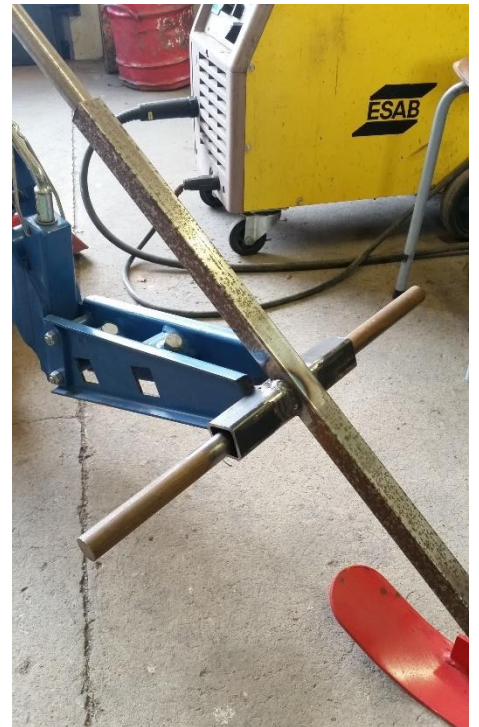
Figur 18: Massivt rundstål sveiset fast for å kunne henge på ekstra vektbelastning. Foto av forfatter, 2016. Brukt med tillatelse.
