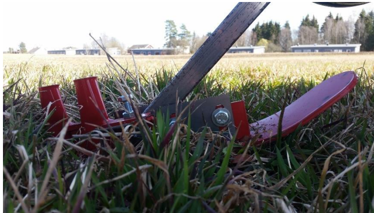
Figur 41: På grunn av ansamling av plantemateriale foran knivene, ble såskia løftet opp i fremkant, og laget dermed dårlige eller ingen skår. Foto av forfatter, 2016. Brukt med tillatelse.
