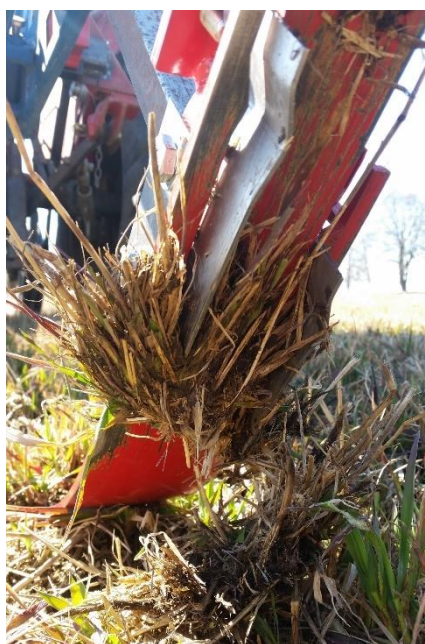
Figur 40: Opphoping av plantemateriale foran kniv med 60° skjærvinkel. Slik var det i de fleste tilfeller ved denne og 90° skjærvinkel. Foto av forfatter, 2016. Brukt med tillatelse.
