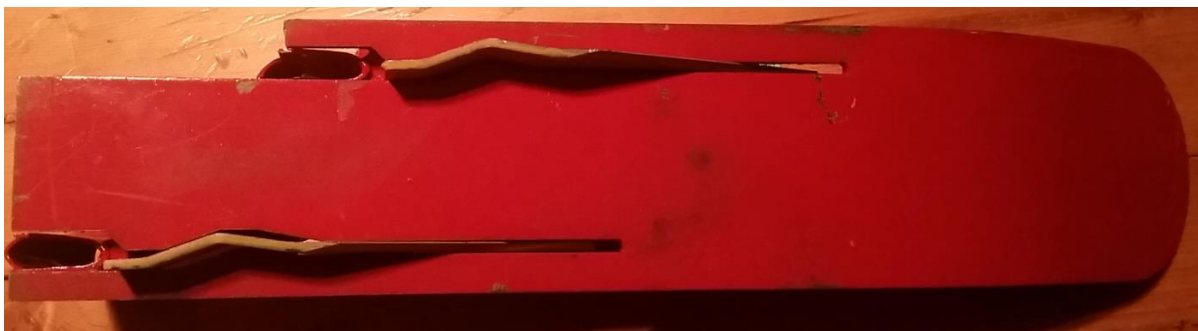
Figur 10: Såskia sett fra undersida. Her ser vi at knivene har en knekk og er svakt skråstilte. I bakkant av knivene (til venstre i bildet) er nedslippet til frøene. Foto av forfatter, 2015. Brukt med tillatelse.
