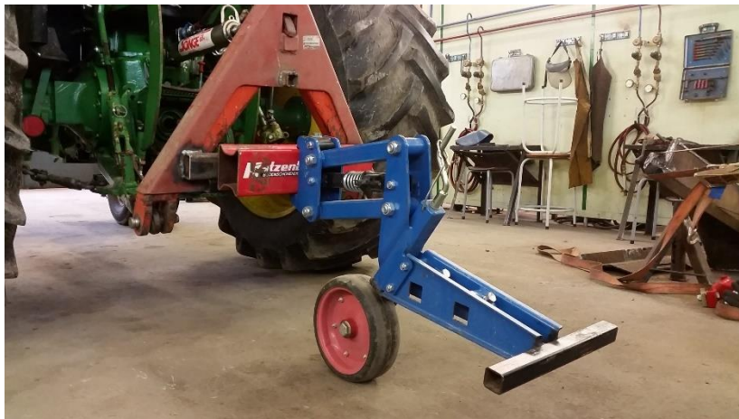
Figur 15: Rammerøret fra Hatzenbichler ble skrudd fast til den påsveisede firkantprofilen på triangelkoblinga. Redskapslabben ble sentrert på rammerøret og låst fast. Foto av forfatter, 2016. Brukt med tillatelse.
