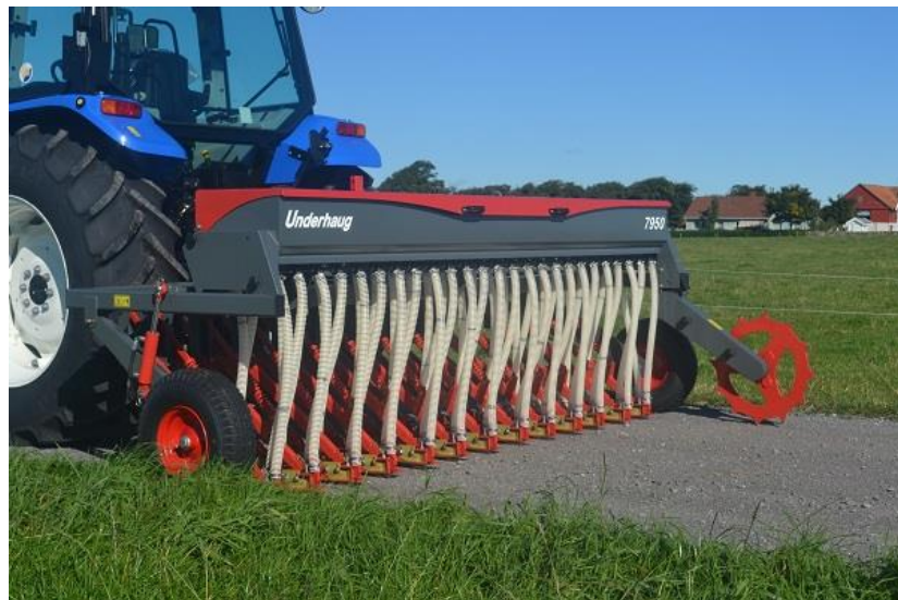
Figur 7: Slik ser direktesåmaskinen fra Underhaug AS ut. Dette er bilde av maskinen med 3 meter arbeidsbredde og 25 såski. Foto: Underhaug AS.
