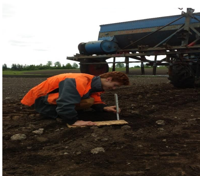
Figur 27. Måling av dybde, av forfatteren 2016.
