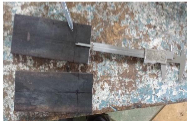
Figur 16. Måling av senter hull til toppstagsbolt, kat. 2, av forfatteren 2016
