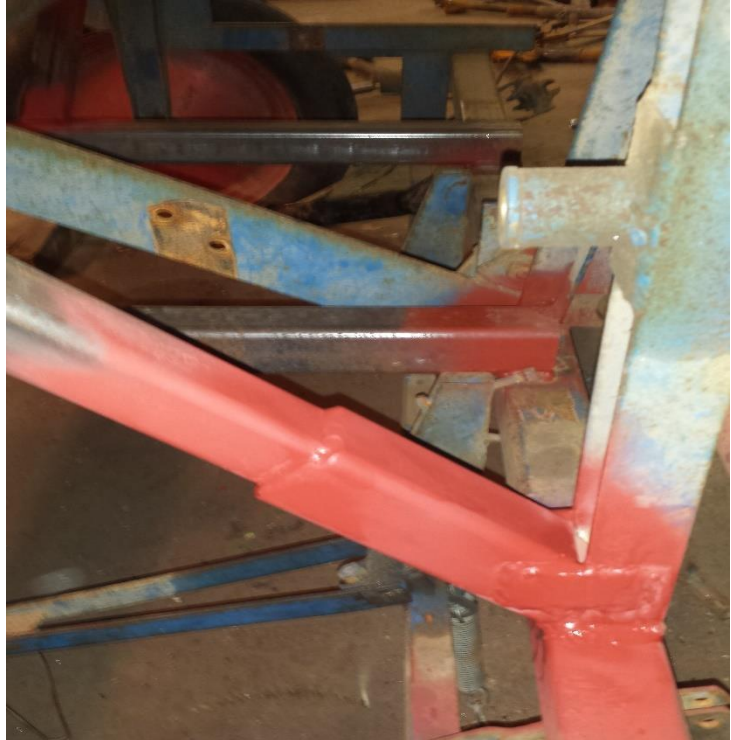
Figur 15. Skråstiver fastsveiset på eksisterende 3-punkt, av forfatteren 2016.
