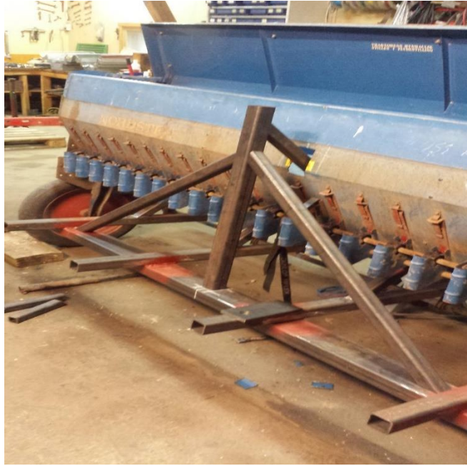
Figur 20. Ny geometri bak såmaskinen, av forfatteren 2016.
