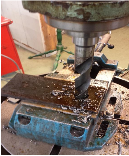
Figur 17. Boring av kategori 2 hull toppstagbolt, av forfatteren 2016.
