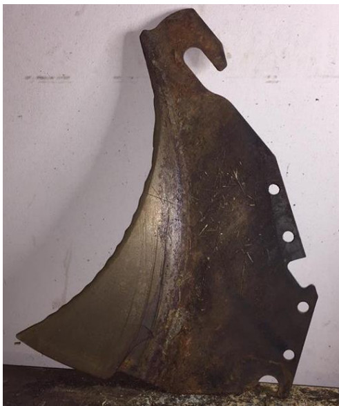
Figur 8 Kuttekniv av typen som benyttes i lessevogner og presser, av forfatteren, 2017.
