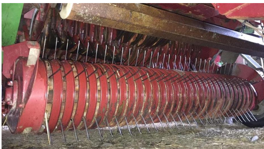
Figur 7 Pickup på lessevogn, av forfatteren, 2017.
