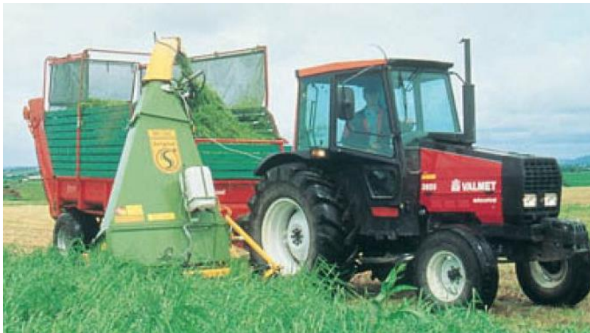
Figur 13 Serigstad fôr høster. Denne kan kjøres både som rein slag høster og som multikutter. Av Bedre Gardsdrift. Brukt med tillatelse.
