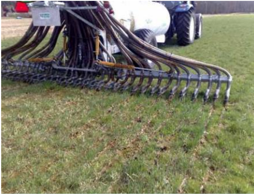
Figur 18: Grunn nedfelling. "Husdyrgjødsel på grasmark", u.å., av Heggset.
