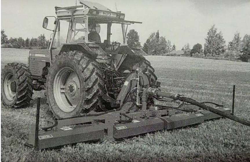
Figur 19: Trykkinjeksjon (DGI). "Direkte gjødselinjeksjon", av Morken, (Morken, 2003, s. 138).
