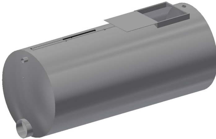
Figur 37: Tank med påfyllingsluke for gjødsla, av forfatterne, 2019.
