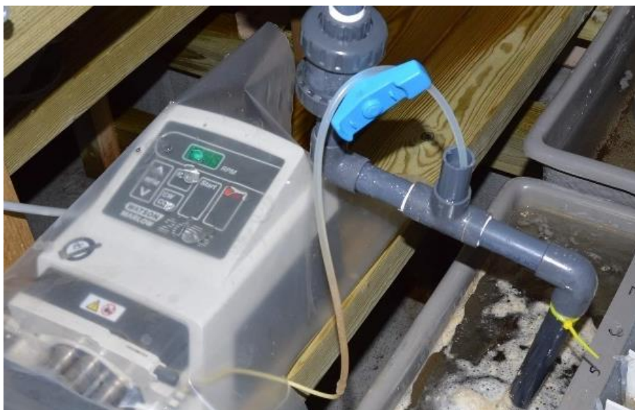
Figur 7. Silikonslangen plassert i stigerøret for å tilsette doseringsløsningen, på bildet kan man også se en av de peristaltiske pumpene som ble benyttet til å tilsette doseringsløsningen i riktig mengde.
