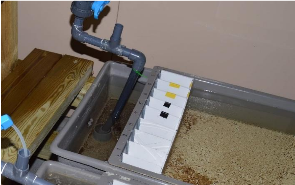
Figur 6. Blandemekanismen for innblanding av doseringsløsning vises i bunnen av kleskerrennen, foran kleskebakken. Kleskebakkene ble modifisert ved at bunnen ble skåret ut og erstattet med en PVC-plate og en perforert plate i fremre del (1 x 1 mm perforering). Fremre del var seksjonert med PVC-plater i 8 like store eksponeringkamre (6 x 10 x 14 cm) hvor dyrene, ett i hvert kammer, ble eksponert under forsøkene.
