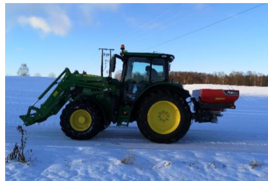
Figur 3: John Deere 6130R med Kverneland Exacta CL Geospread ved overgjødslingen den 5.12.2019. Foto Lars Gunnar Flatvad
