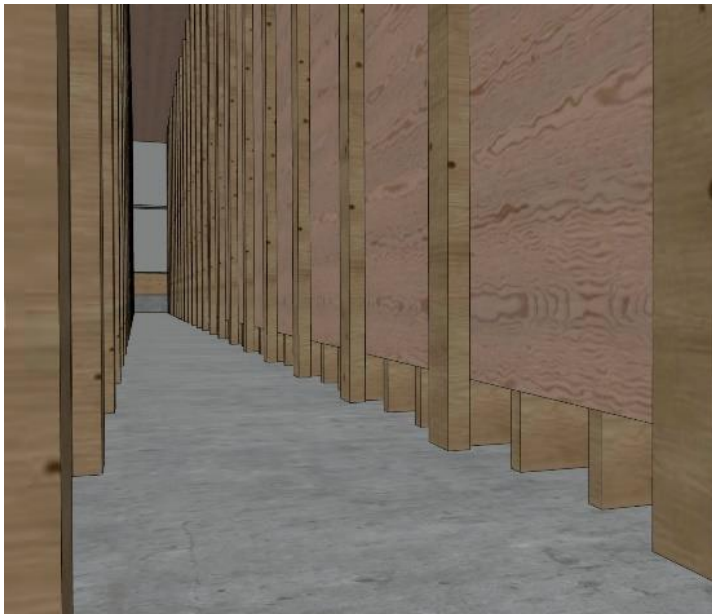
Figur 10 viser 3D-bilde av luftekanalen, der man kan se flere luftekanaler som går under gulvet. Tegning: Amund Løken
