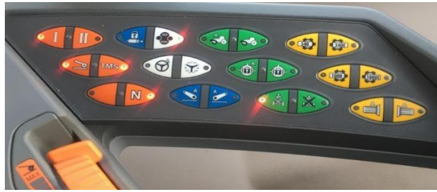
Figur 4. Panelet i armlenet med trykknapper. Foto: Erik Solbjørg, 11 mars 2020.
