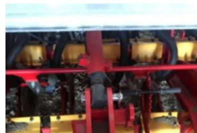
Figur 31. Fjærene sitter under, og bakover fra stagget for parallelliteten. Foto: Erik Solbjørg, 9 april 2020.
