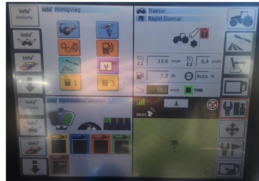
Figur 5. "Hjem"-skjermbildet på varioterminalen. Foto: Erik Solbjørg, 11 mars 2020
