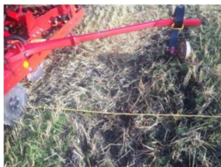
Figur 37. Justering av markører, målt fra ytterste skål på hver side. Foto: Erik Solbjørg, 18 september 2019.
