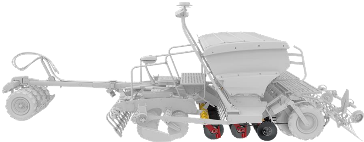
Figur 6 Så og gjødselorgan på direktesåmaskin (Produktinformasjonsside for Väderstad Rapid, 2020)
