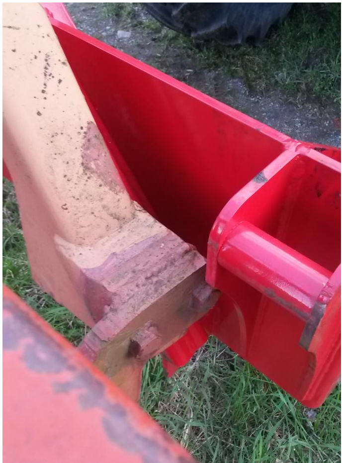
Figur 4.8 Buttende Triangel-redskapskobling i Euro-kobling på prototyp. Høgskolestudent, av forfatteren, 2015. Brukt med tillatelse.
