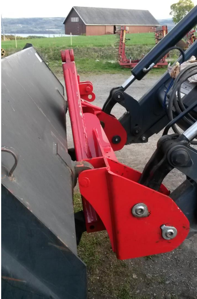
Figur 4.9 Påkoblet Euro-kobling med originale Euro-fester. Høgskolestudent, av forfatteren, 2015. Brukt med tillatelse.
