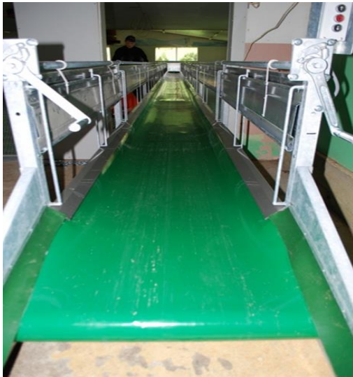
Figur 1: Ved siden av det rullende fôrbrettet, ser en spisefronten og vinsjen som benyttes ved åpning eller lukking av etefront (Etefront og rullende fôrbrett, fra Fjøssystemer, 2015).
