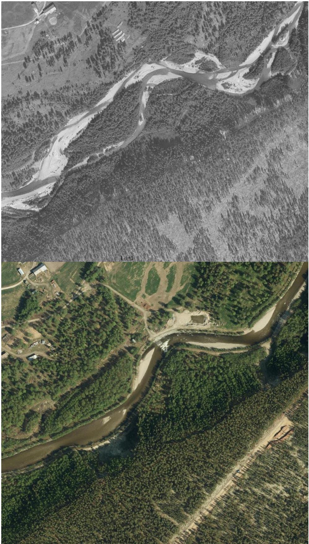
Figur 9. Detaljbilde fra 1969 (øverst) og 2018 (nederst) som viser forskjellen mellom en forbygd elv med terskel og en mer naturlig elv, der det dannes flomløp og meandre.
