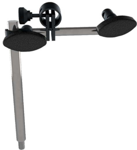
Figur 5.8 Konsept 1, ledd fra indikator klokke. Gjenskapt i Inventor.
