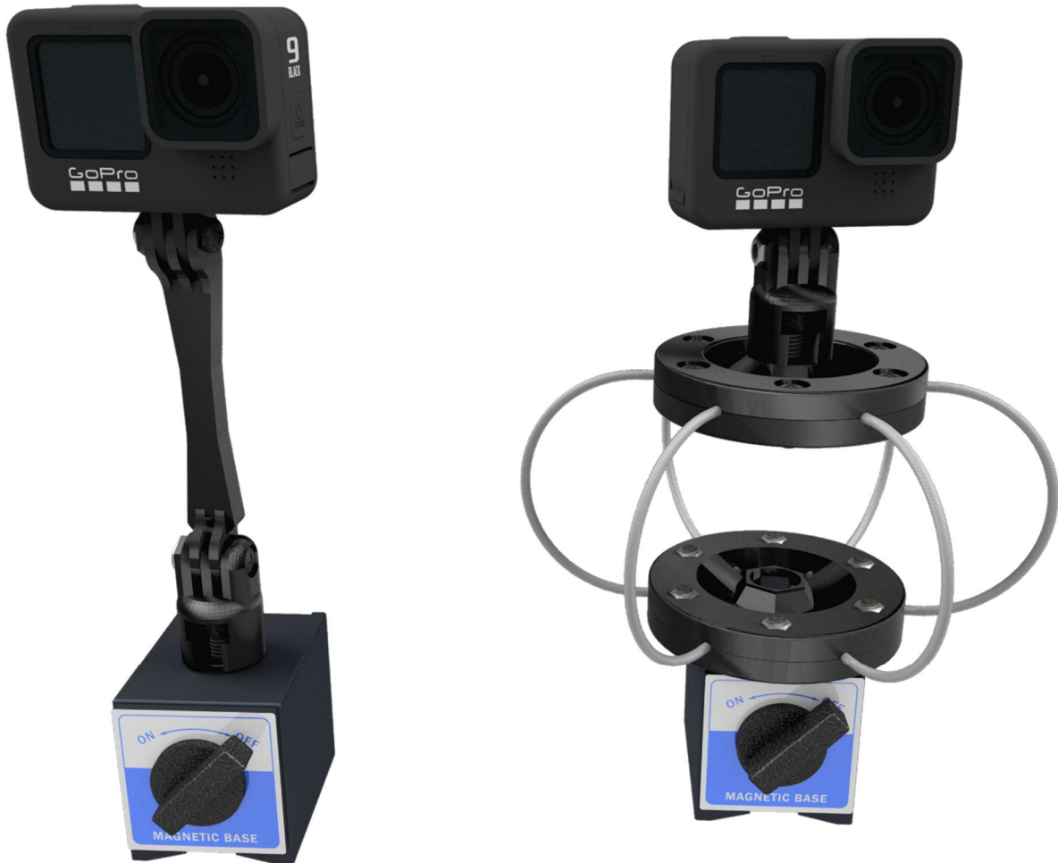
Figur 7.1 Modeller av kamerafeste, laget i Inventor.
