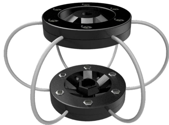
Figur 6.1 forbedret vibrasjonsdemper, bilde fra Inventor.
