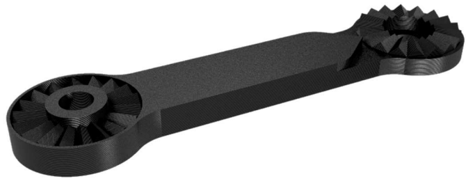
Figur 5.9 Konsept 2, et ledd uten endeovergangene. Bilde fra Inventor.
