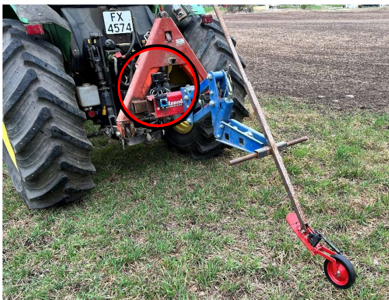
Figur 7.7 Bilde fra funksjonstest på Blæstad. Rød ring der kamerafestet er.
