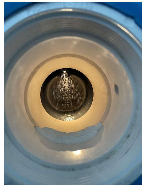
Figur 2: Simulert nedbør i vindtunnel
