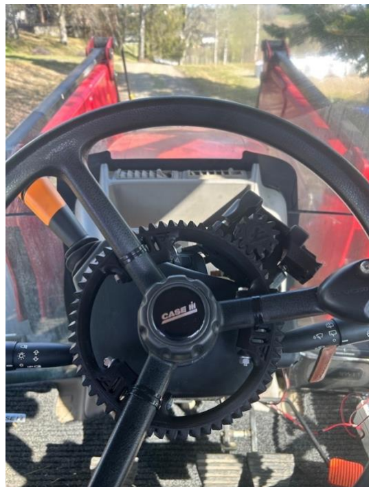
Figur 36: Viser tannhjul og rattmotor. Foto: Ingeborg Hogne, 2023.
