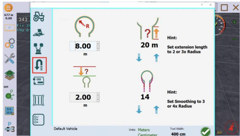
Figur 17: innstillinger for u-sving på vendeteigen. Foto: Ingeborg Hogne, 2023.
