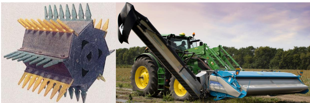
Figur 12. Strippermetoden brukes også for å høste bladene til industrihamp. Bildet til venstre viser en forholdsvis smal slager som ble testet på en prototype. Til høyere er et frontlastermontert redskap til traktor. Fra Bruce et al., 2001, s. 45; Shelbourne Reynolds, u.å.
