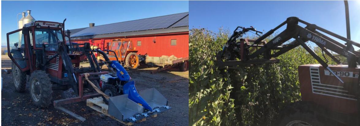
Figur 5. Endrerud testet 11. oktober 2022 en dobbeltknivslåmaskin til å kutte av og høste stengler, med bladene på. Foto: Ole Sigurd Lodsby.
