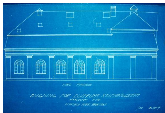
Ill 9.5: Elverums Biografens fasade mot nord som viser rundbuevinduene inn mot salens langvegg.
