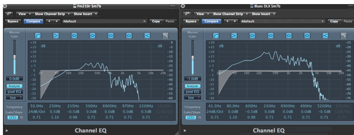
Bilde 8 Demonstrasjon over forskjell i frekvensspekteret ved bruk av forskjellige gitarforsterkere.
