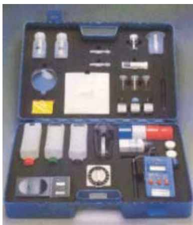
Bilde 1: Testkoffert fra Sandberger. Inneholder utstyr for pH-målinger, nitrogen- og sulfidtester i felt (foto: Sandberger GmbH, A)
