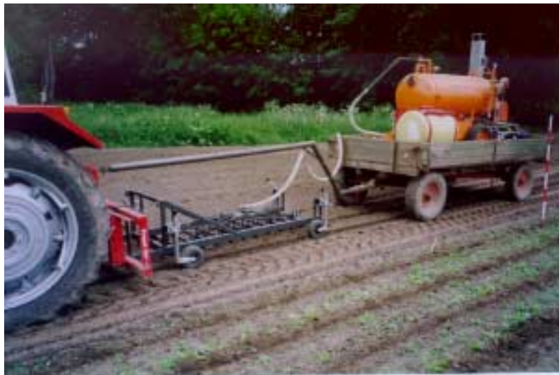
Figur 3. En prototype på en sribedamper med en 200 kW dampgenerator. På rammen ophængt i traktorens 3-punktsophæng er der på langs monteret 13 dampdyser dannende en 7 cm bred zone, som dampes ved nedsenkning af dyserne i jorden.
