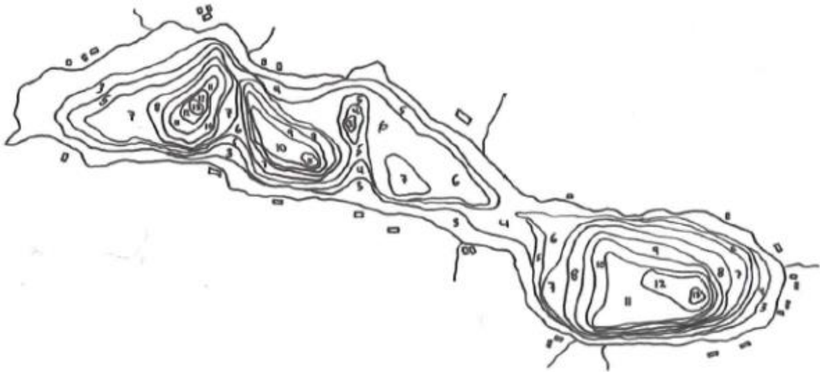
Figur 2. Dybdekart over Melingen. Dybdekartet er utarbeidet manuelt ved hjelp av ekkolodd av typen Wideeye Huminbird fra Seatronic, og kartet er håndtegnet deretter (Veierød, 2012).
