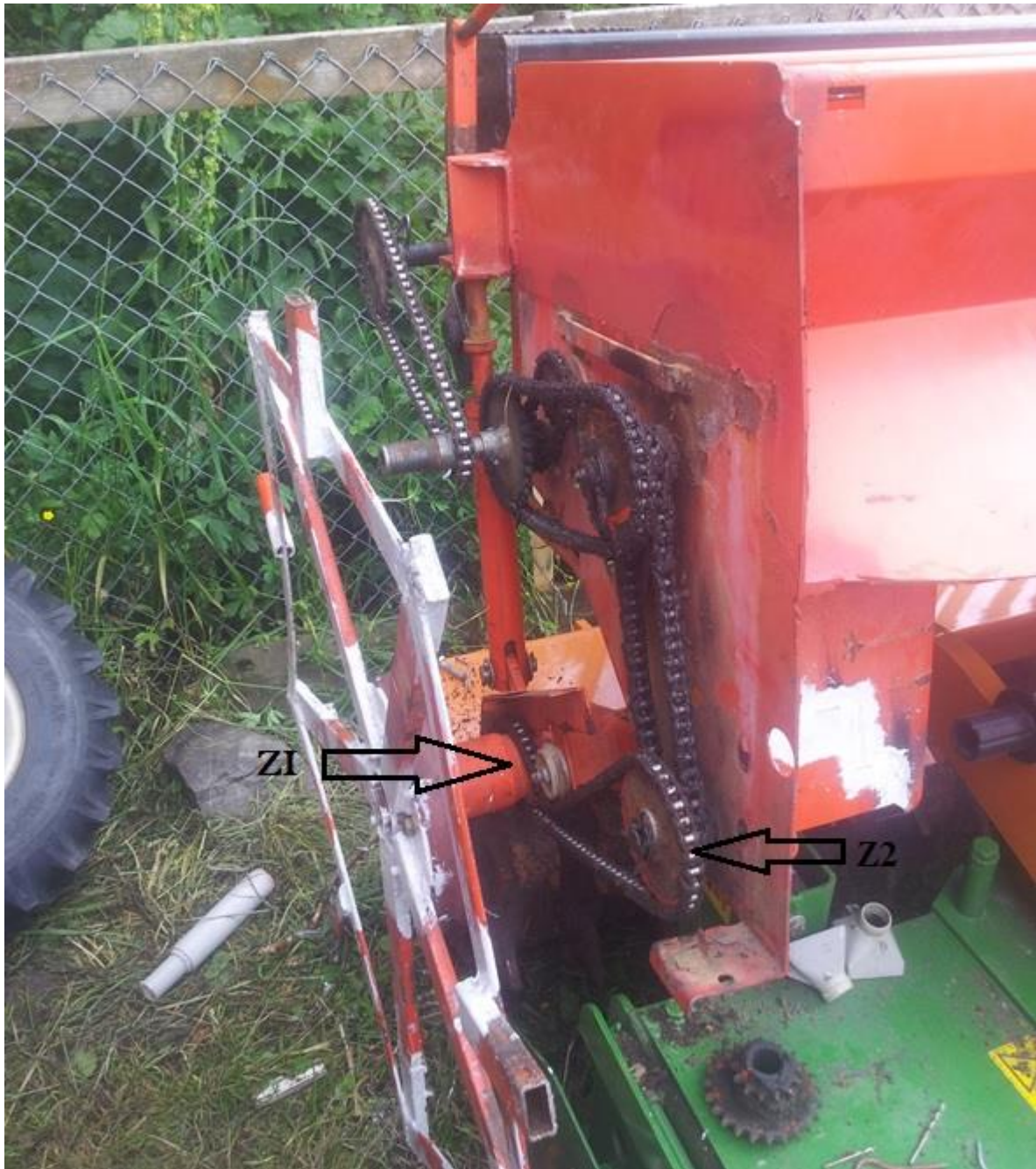
Figur 6. Komplette drivlinje før omdreving til 16 tenner på Z2. I midten av bildet ser man kjedet mellom drev Z1 og Z2, av forfatteren, 2015. Brukt med tillatelse.
