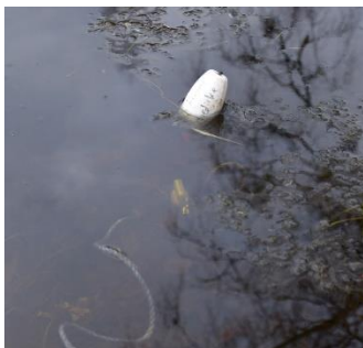
Figur 7: Temperaturloggeren i Åklangengdammen. Den var fiksert på 30 cm vanddyb ved hjelp av et flyteelement og et lodd som forankret den til bunnen. Den var også forankret til land slik at den enkelt kunne tas opp igjen. Foto: Tom Arne Grini
