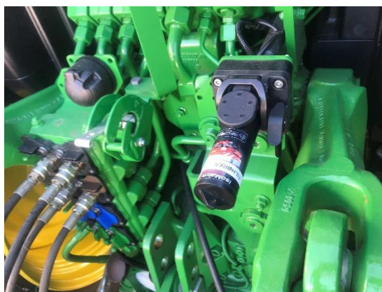
Bilde 7 Viser Kverneland Geospread stikk i ISOBUS kontakt på JD6130R. Foto: Forfattere, den 19.3.2019
