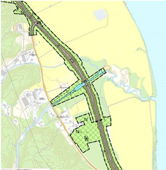
Figur 1: Reguleringsplan for omlagt Rv. 3 over elva Rogna (prosjekt Rv. 3 Evenstad - Imsroa S).
