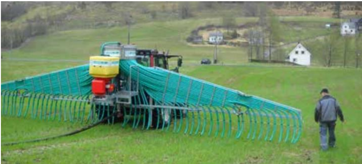
Figur 1-18: Eksempel hvor det brukes våtsåing til engfornyning. Her blir frøene fordelt sammen med gjødsel før det slippes på bakken. (Heggset, et al., 2022)
