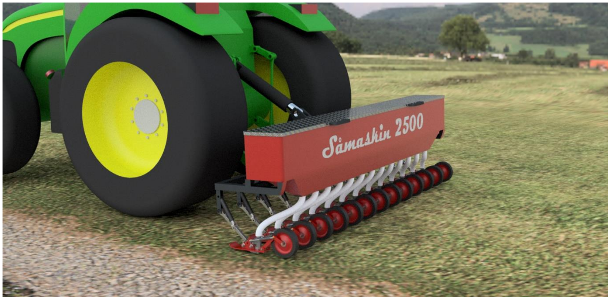
Figur 3-29: Bilde som viser komplett sammenstilling av 2,5 meter såmaskin med sålabber (Foto: Privat)
