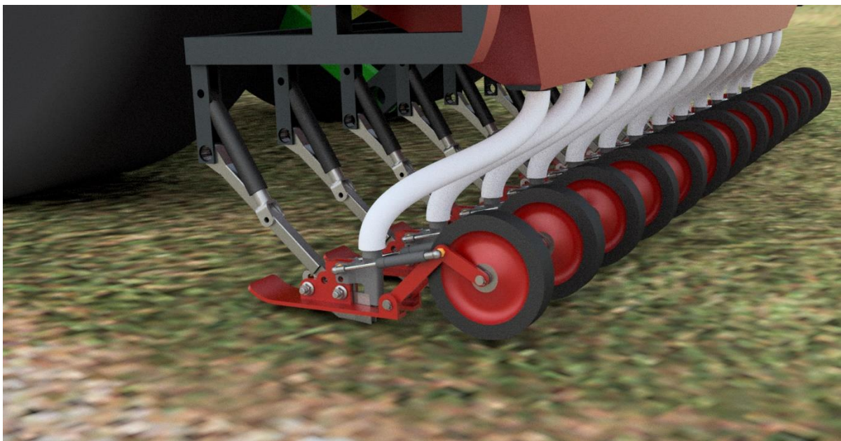
Figur 3-30: Bilde som viser forslag til hvordan sålabben kan festes til såmaskin (Foto: Privat)
