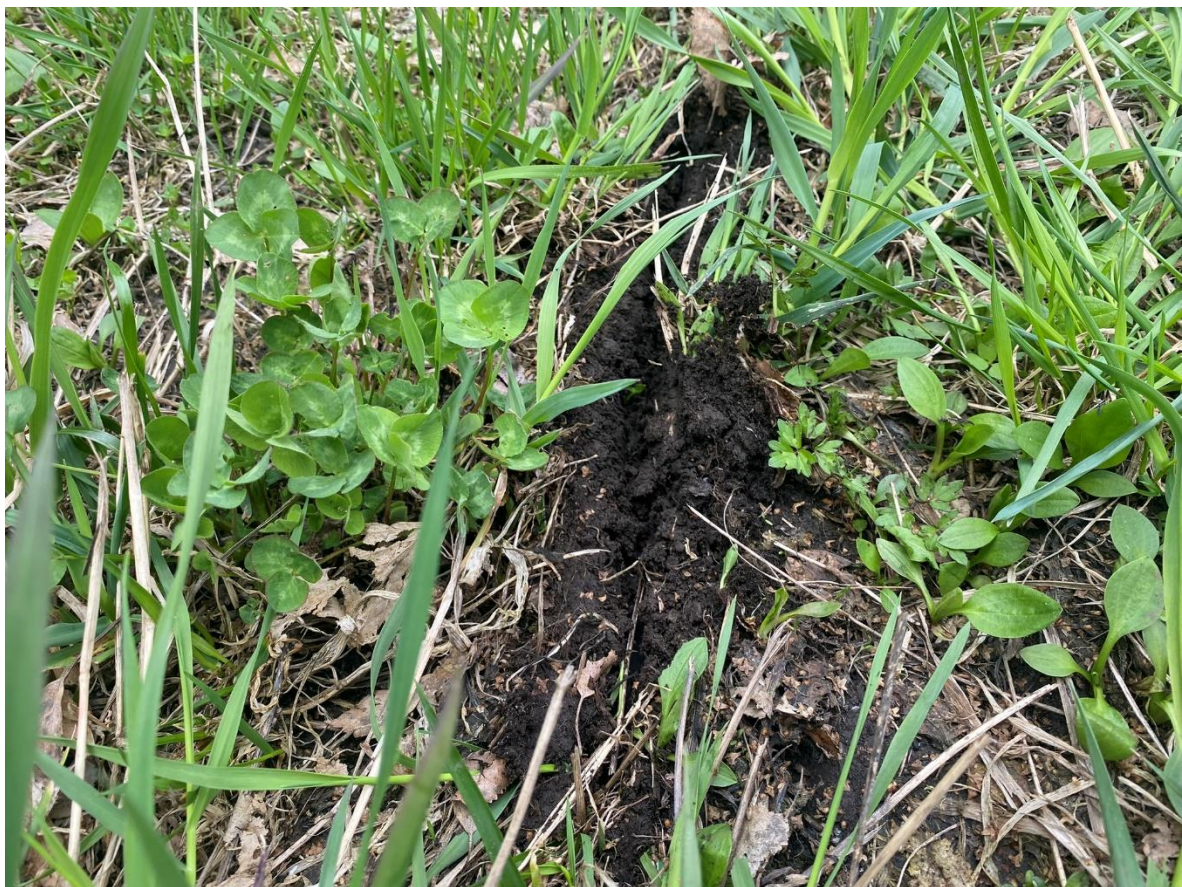
Figur 4-7: Bilde som viser spor etter kjøring med 15 kg ekstra vekt. (Foto: Privat)
