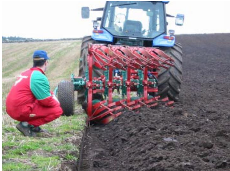
Figur 1-8: Bilde som illustrerer plogens virkemåte og viser resultatet. (Kverneland AS, 2021)
