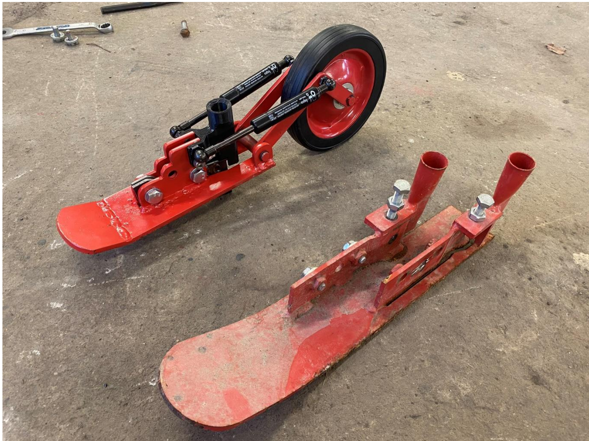
Figur 3-1: Bilde som viser Underhaugs sålabb (nederst) og nyutviklet sålabb (øverst). (Foto: Privat)
