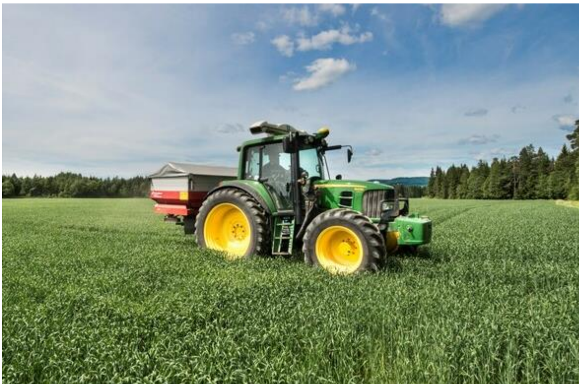
Figur 1-12: Kunstgjødselspredning i eng. Her vist med traktor og takmontert N-sensor fra Yara. (Yara International ASA, 2022)
