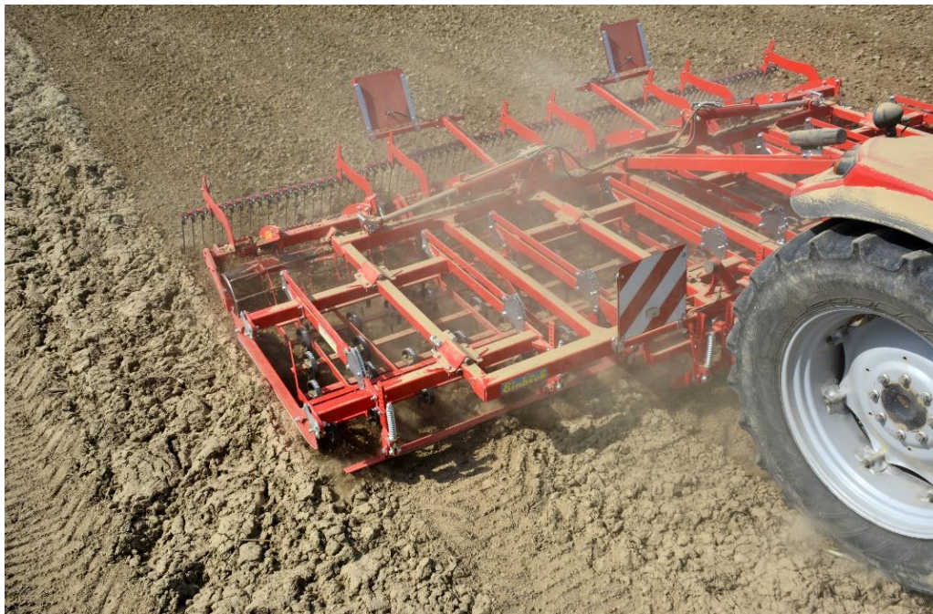
Figur 1-9: Såbedsharv som knuser klump og tilrettelegger godt såbed. (Einböck GmbH, 2022)
