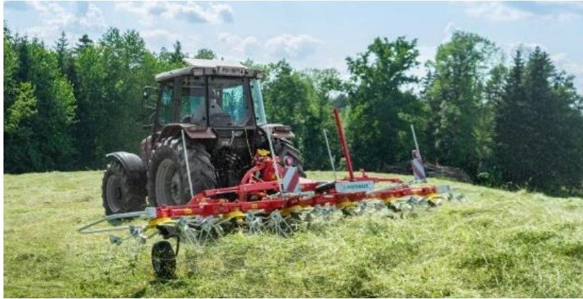
Figur 1-10: Bilde som viser funksjonen til en sprederive/rotorvender. (PÖTTINGER Landtechnik GmbH, 2022)
