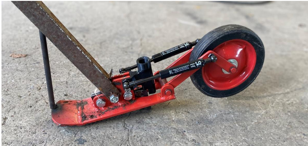
Figur 4-4: Bilde som viser fastsveiset stag som skal hindre vippling av skien under gange. (Foto: Privat)
