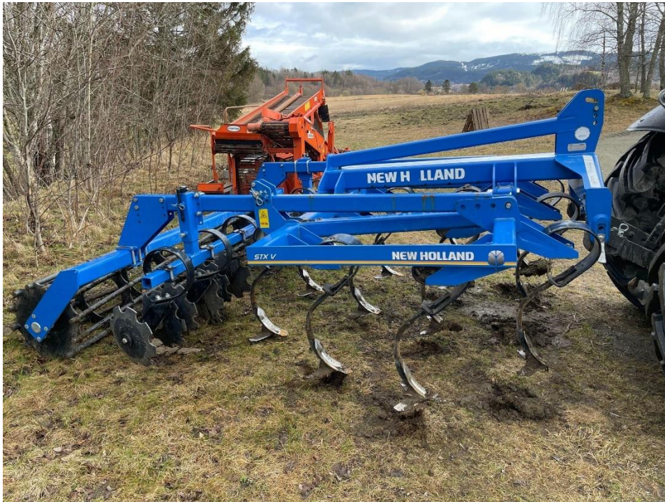
Figur 8. New Holland STX V 300R. Foto: Peder Kvaal.
