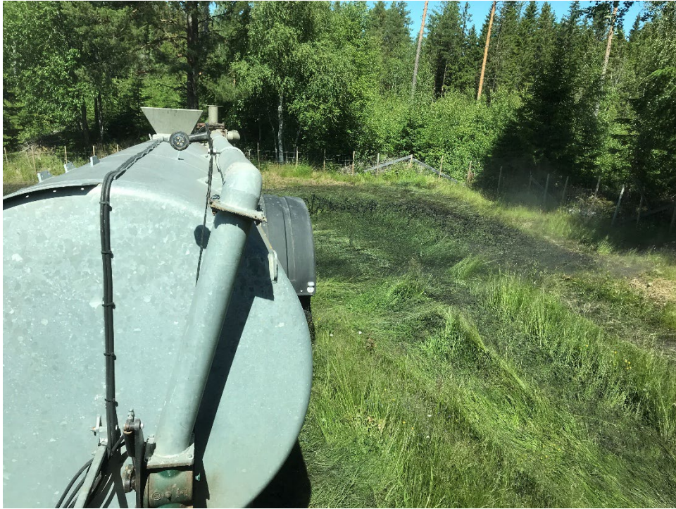
Bilde 11 viser spredning med fanespreder av bløtgjødsel iblandet Biokull på eng.
