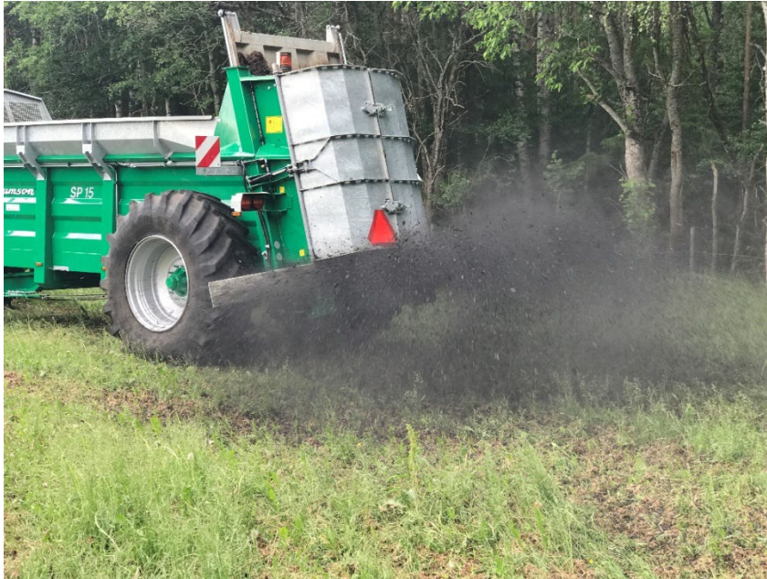
Bilde 7 viser Samsung tørrgjødelspreder i aksjon med spredning av Biokull. Sprederen har her både hydraulisk bakluke og ekstra bakluke bak spredevalsene for å få lav spredning.
